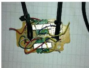
入力側は、ヘッドホンステレオ向けでミニプラグ付きのケーブル出し。出力側はアンプ向けに RCA プラグ付きのケーブルにして手持ちのタカチのケースに入れました。
