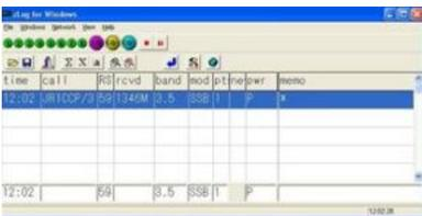
左図は入力エラーの画面例。Shift+enter で強制登録できますが、後で修正・再計算が必要です
