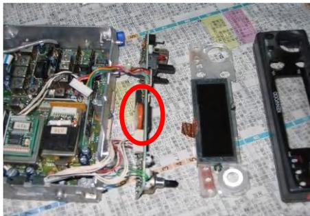
アップ用のリード付きのリチウム電池を探したのですが、店頭にはありません。しかたなく、ホルダーを購入し、ケーブルの半田で対応しますパネルを外した時にプッシュボタンが転げ落ちました。抑えと戻りを兼ねたスポンジが劣化して溶けてベトベトになっています。アルコールを含
