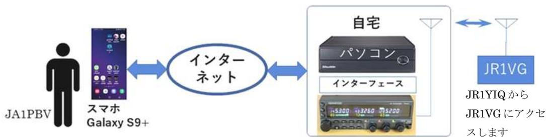
出先でスマートフォンを使い、インターネットを介し自宅のパソコンのソフトに入り、ソフトから無線機を操作し電波を出す。JR1VG のアクセスを確認し、送受信します。
